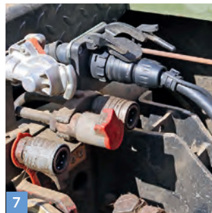
7 | Der MB-Trac von Manfred Hoffie wurde mit einem ISOBUS-Kabelsatz nachgerüstet.
